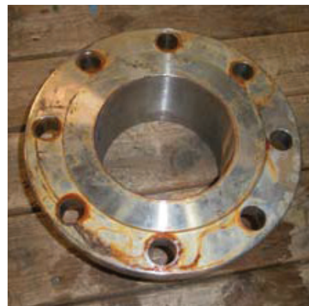
Рис. 5. Кромка RVS 304 под воздействием железистой воды.
