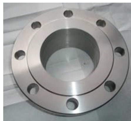
Рис. 6. Та же кромка, что и на рис. 5, но очищенная Innosoft B570 и покрытая нанослоем.
