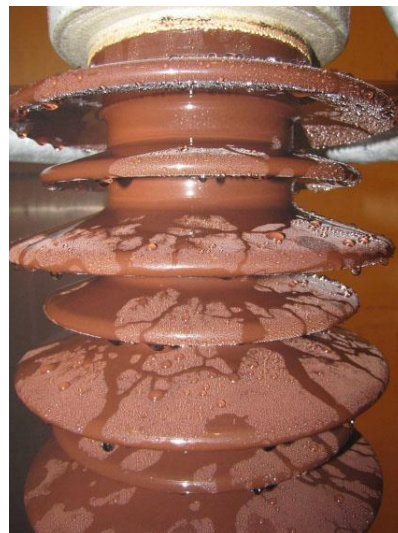
Рис. 4. Фотографии, показывающие состояние обработанных опорных изоляторов после испытаний в FGH, Мангейм.
