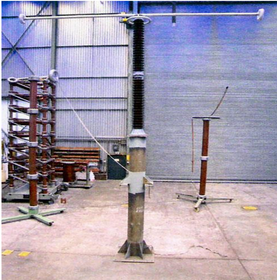
Рис. 3. Опорный изолятор, установленный в лаборатории высоких напряжений, готовый к испытаниям в FGH, Мангейм.
