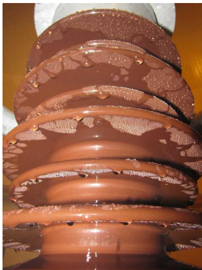
Рис. 4. Фотографии, показывающие состояние обработанных опорных изоляторов после испытаний в FGH, Мангейм.
